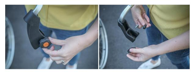
2. Desserrer les deux petits pas de vis à l'arrière de l'appui-tête à l'aide de la clé 6 pans de taille 3.
