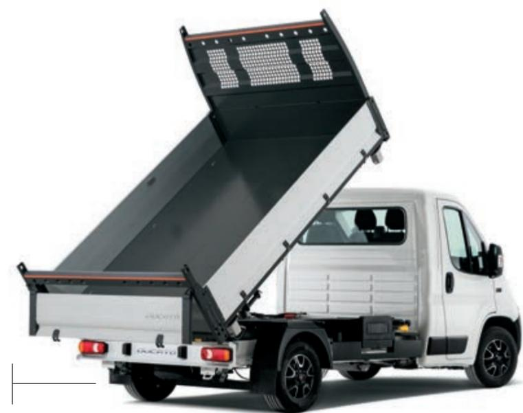
Version à benne basculante arrière.
