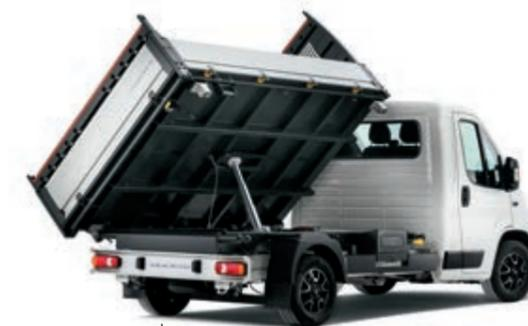
Version à benne basculante traverse.
