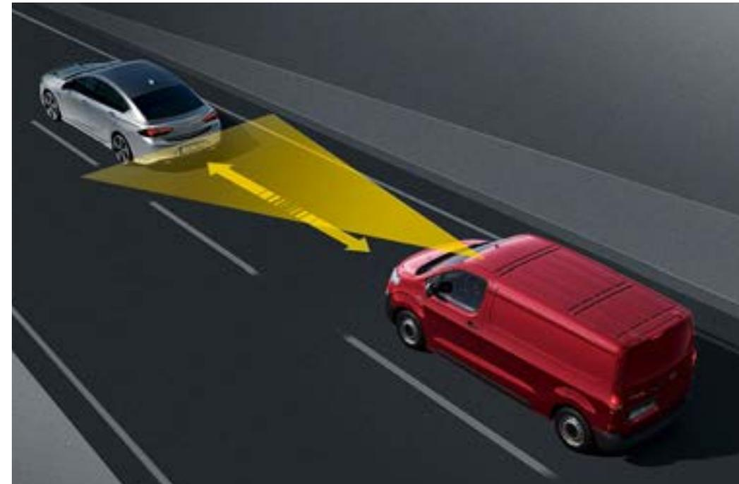
**Régulateur de vitesse adaptatif<sup>1</sup>.** A des vitesses entre 30 et 160 km/h, le système maintient une distance de sécurité définie avec le véhicule qui vous précède. L'accélération et le freinage automatiques rendent les longs trajets très confortables.
