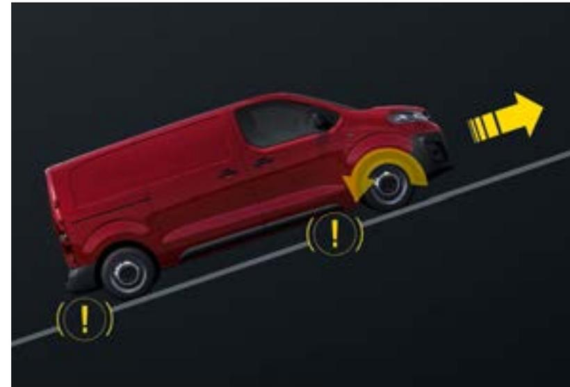
**Assistant de démarrage en côte<sup>1</sup>.** Empêche brièvement le véhicule de reculer dans les pentes. Le frein est relâché dès que le moteur fournit suffisamment de couple pour compenser la pente.
