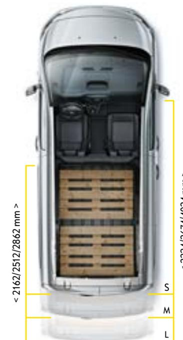
Pour se conformer parfaitement à vos exigences, le Vivaro existe en trois versions: S, M et L. Chaque taille combine des dimensions extérieures compactes avec un intérieur spacieux et flexible. Idéale en ville, la version S de seulement 4,60 m de long peut accueillir jusqu'à deux europalettes. Quant à la version moyenne, elle peut facilement transporter trois europalettes.
