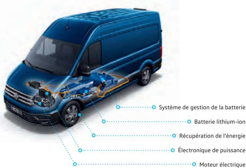
Les composants du système de propulsion électrique sont logés dans le soubassement du véhicule offrant stabilité et maintien du volume de chargement.
