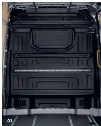
**01 Cloison de séparation sans fenêtre.** Cette cloison de séparation selon la norme DIN 75 410-3 est constituée d'un panneau plein parfaitement vertical. Un rangement de toit, au-dessus de la cabine de conduite est disponible en option pour le toit surélevé (H3). Il est de série sur la version toit superélevé (H4). |VA|
