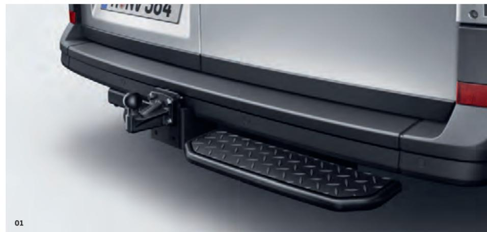
**01 Support de montage et marchepied.** Le support de montage facilite le changement de dispositif d'attelage (boule, mixte ou à broche).<sup>1)</sup> Le marchepied en option optimise et sécurise l'accès ou la sortie à bord du véhicule.<sup>2)</sup> | VA | PC |
