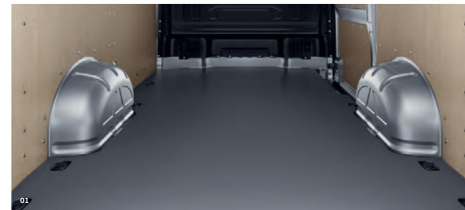
**01 Plancher bois<sup>1), 2)</sup>.** Le plancher bois de 8 mm d'épaisseur, dans l'espace de chargement, crée une surface stable optimale, pour votre chargement. Essence de bois robuste, le hêtre est très stable et d'une longévité exceptionnelle. | VA |
