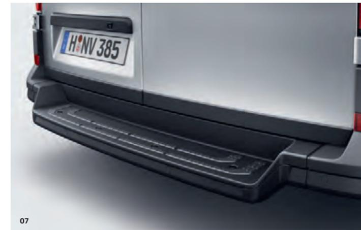
**07 Marchepied intégré dans le pare-chocs arrière.** Il s'étend sur toute la largeur du véhicule et facilite le chargement et le déchargement. | VA | PC |
