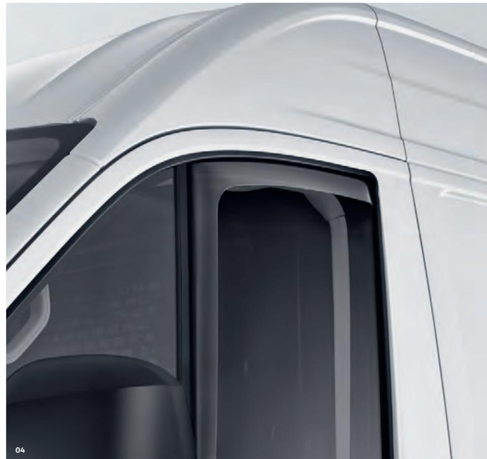
**04 Déflecteurs de vent et de pluie.** Lorsque vous conduisez avec la fenêtre entrouverte, les déflecteurs réduisent efficacement les projections d'eau et les bruits aérodynamiques importuns et font office d'écran protecteur contre l'ensoleillement latéral. | VA | PL | CH | PC | BE | CG |
