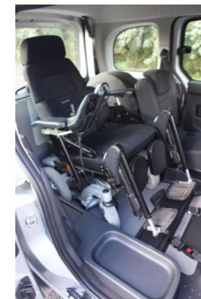
\*NB : le siège passager arrière gauche peut aisément se rabattre vers l'avant et est escamotable, ce qui permet si nécessaire d'augmenter la largeur utile au niveau des jambes du passager en fauteuil roulant.
